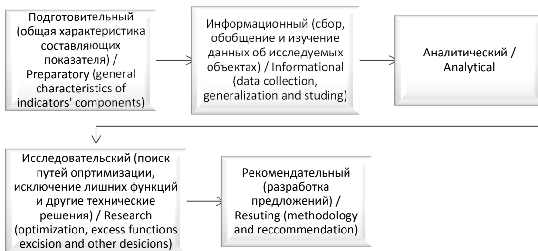
Рис. 2 / Fig. 2. Этапы функционально-стоимостного анализа / Stages of functional-cost analysis
